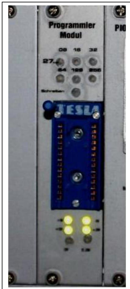
So sieht dann die Front des Brenners aus. Die obersten 6 LED's (PLCC2) zeigen den gewählten EPROM an. Darunter befindet sich eine rote LED, welche beim Schreibvorgang leuchtet.
